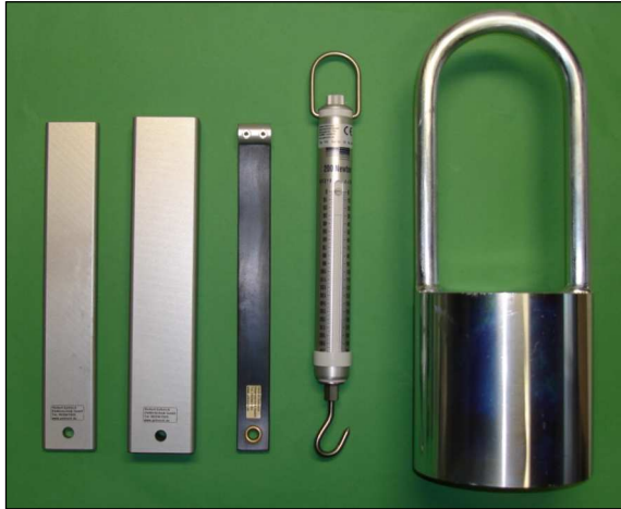
Prüfkörper 1 (Prüfstab: 10mm x 50mm x 300mm) Prüfkörper 2 (Prüfstab: 30mm x 60mm x 300mm) Prüfkörper 3 Federwaage Prüfkörper 4
